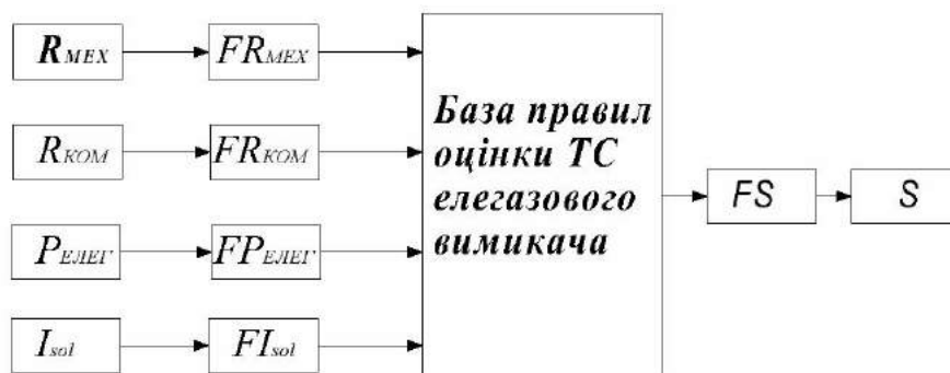
Рисунок 2 – Нечітка модель для оцінки ТС елегазового вимикача: R_{\text{мех}} – значення спрацьованого механічного ресурсу вимикача; R_{\text{ком}} – значення спрацьованого комутаційного ресурсу вимикача; P_{\text{нов}} – значення тиску елегазу; Isol – оцінка стану ізоляторів вимикача; FR_{\text{мех}} – лінгвістична змінна «Спрацьований механічний ресурс»; FR_{\text{ком}} – лінгвістична змінна «Спрацьований комутаційний ресурс»; FP_{\text{нов}} – лінгвістична змінна «Тиск елегазу»; FI_{\text{sol}} – лінгвістична змінна «Стан ізоляторів»; FS – лінгвістична змінна «Загальний спрацьований ресурс»; S – значення загального спрацьованого ресурсу вимикача
