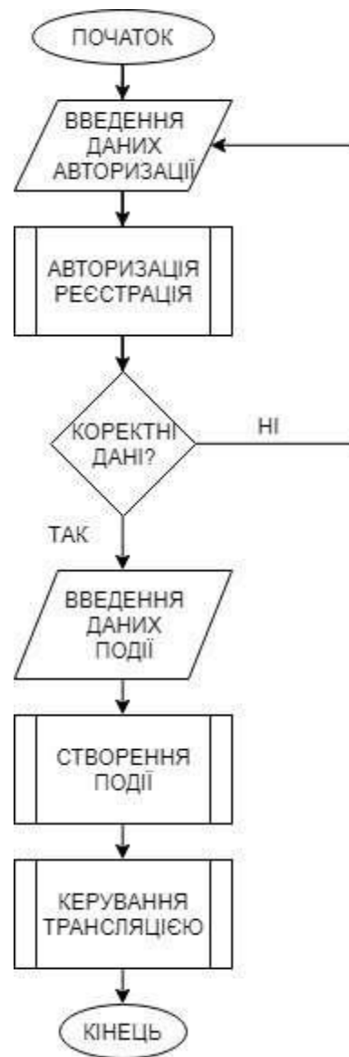
Рисунок 3.2 – Схема функціонування програмного забезпечення для обробки відеопотоків
