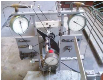
a – вид спереду: 1 – індикаторна голівка, 2 – регулятор гальмівних сил, 3 – манометри; б – вид ззаду: 1 – механічний привід поршня, 2 – регулятор гальмівних сил, 3 – індикаторна голівка Рисунок 1 – Стенд для лабораторних досліджень
