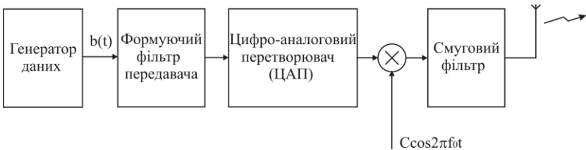
Рисунок 1.5 – Структурна схема модулятора BPSK сигналу
