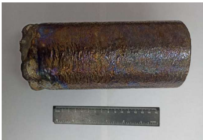
Рисунок 4.1 – Титан-молібденова заготовка катода
