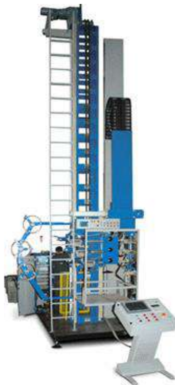
Рисунок 2.4 – Колонна для електрошлакової виплавки
