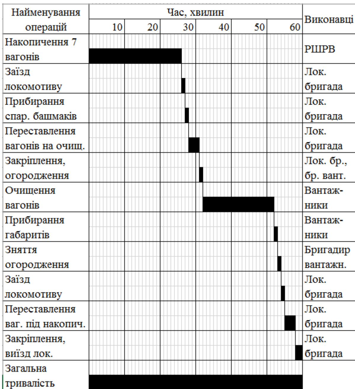
Рисунок 2.7 – Графік очищення вивантажених составів із концентратом, 7 вагонів
