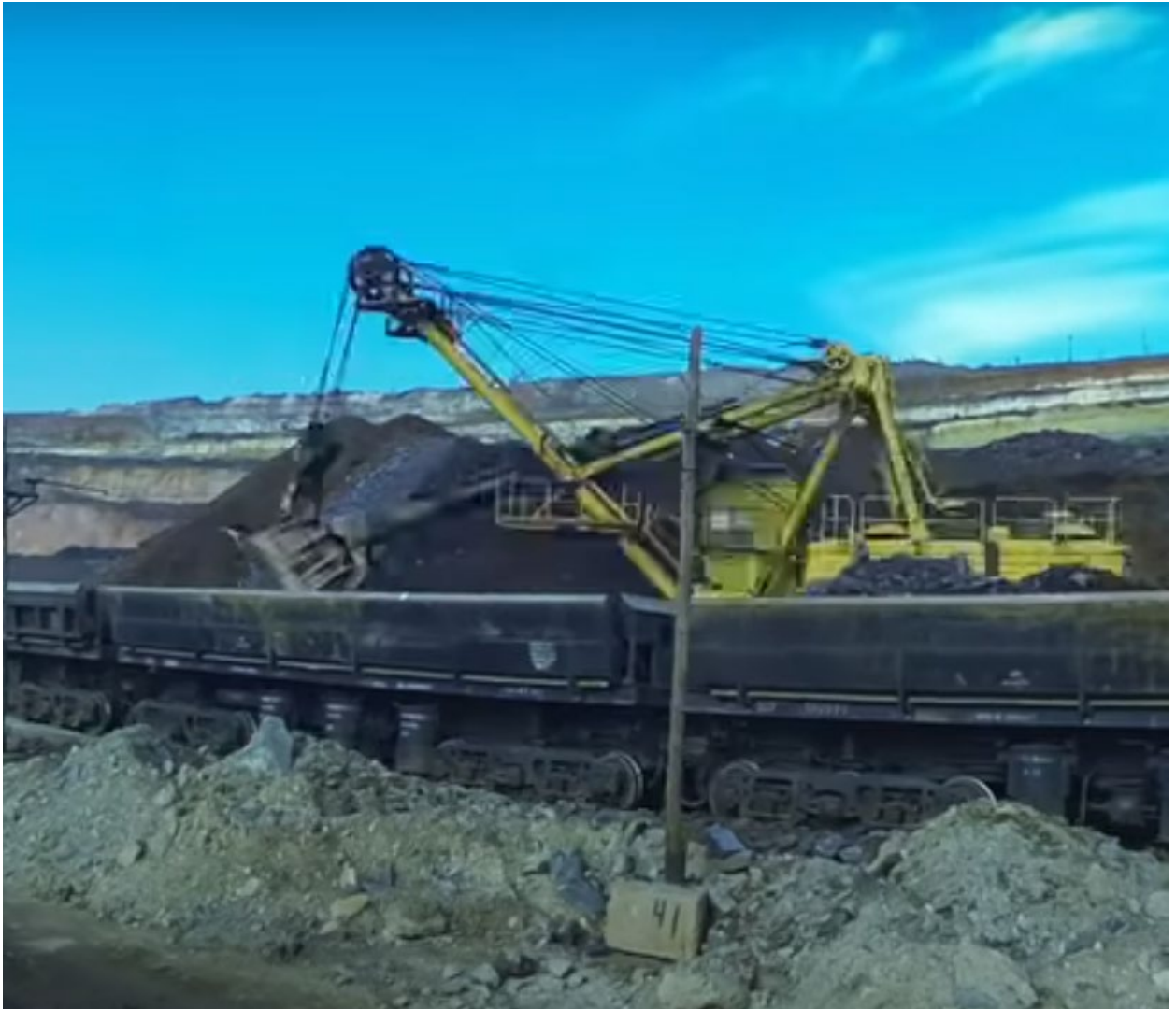
Рисунок 1.10 – Навантаження думпкарів з відкритого складу
