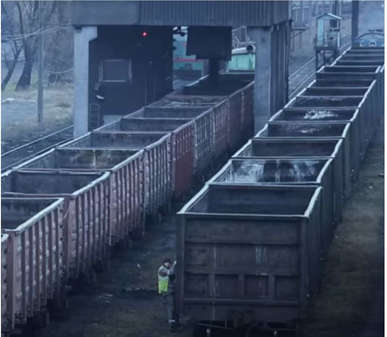
Рисунок 1.5 – Бункерна система навантаження
