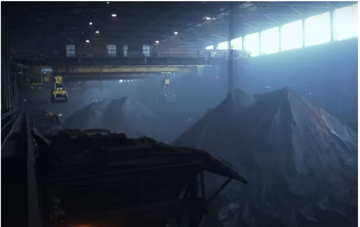
Рисунок 1.9 – Закритий склад залізорудного концентрату
