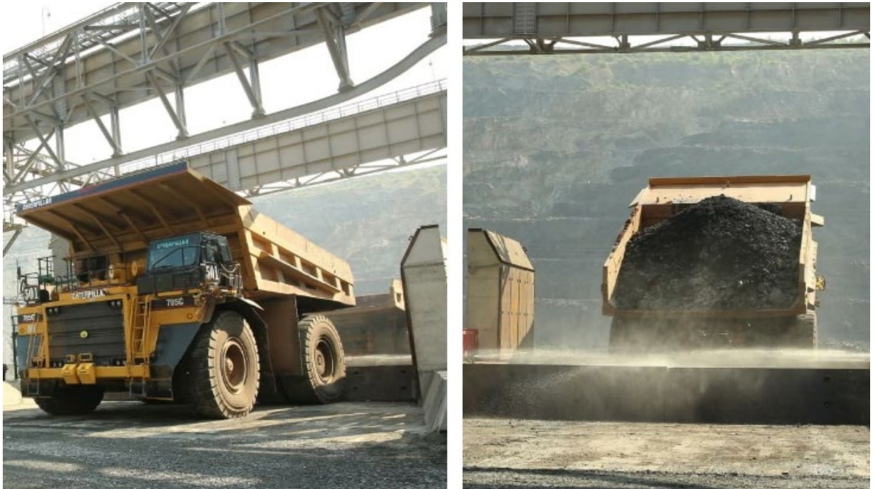
Рисунок 1.2 – Процес розвантаження сировини із самоскидів до пристрою подрібнення
