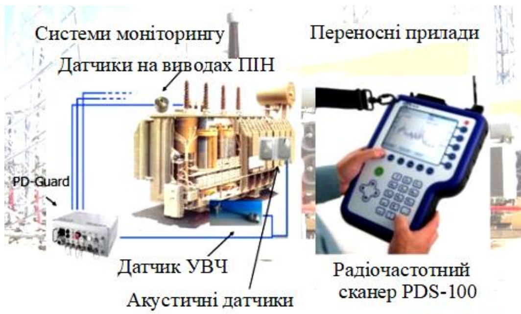
Рисунок 2.6 – Радіочастотні прилади для виявлення часткових розрядів
