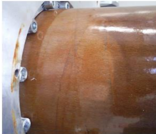
Рисунок 1.3 – Пошкодження поверхні вводу з RIP-ізоляцією [2, 3, 4]
