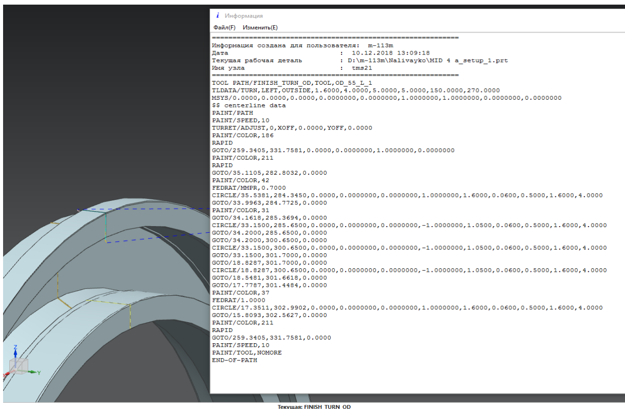
Рисунок 1.12 – Керуюча програма обробки поверхонь операції 030.
