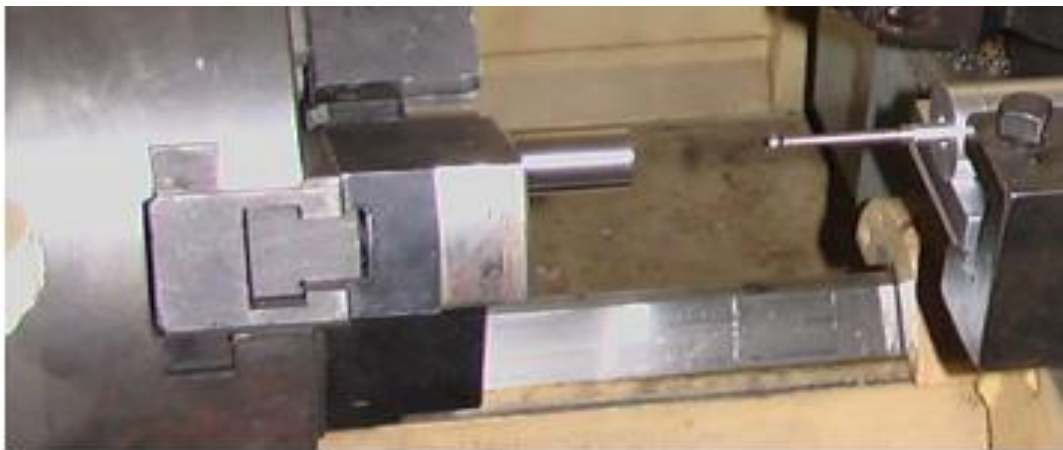
Рисунок 3.1 – Датчик контакту, встановлений в револьверну головку
