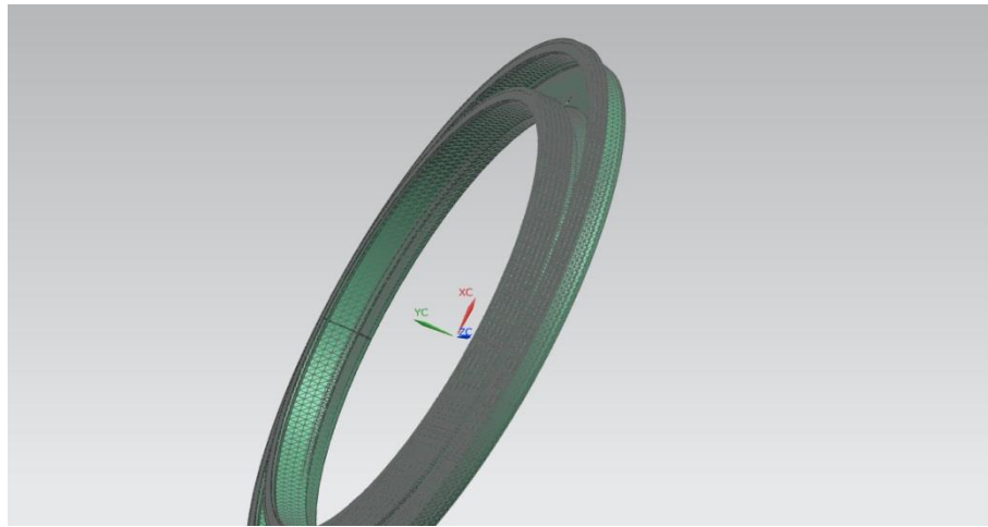
Рисунок 5.2 – Розбиття деталі на кінцеві елементи (сітку).
