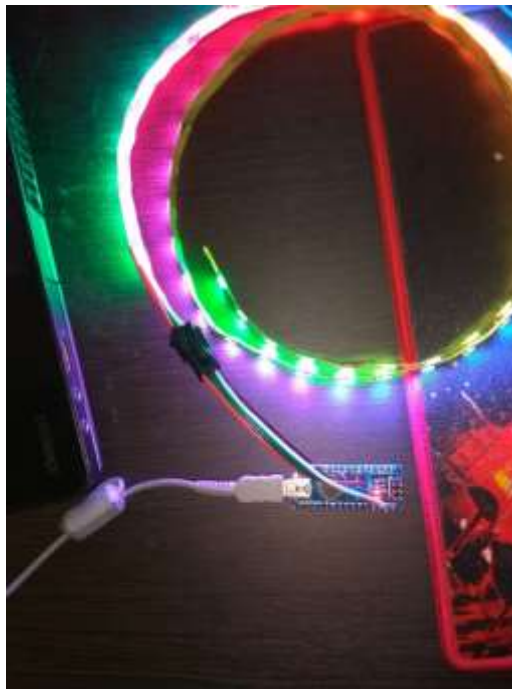
Рисунок 4.4 – З'єднання мікроконтролера та світлодіодної стрічки
