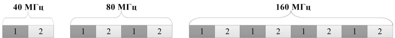
Рисунок 1.14 – Вміст підканалів 20 МГц при передачі полів HE-SIG-B у каналах шириною \geq 40 МГц
