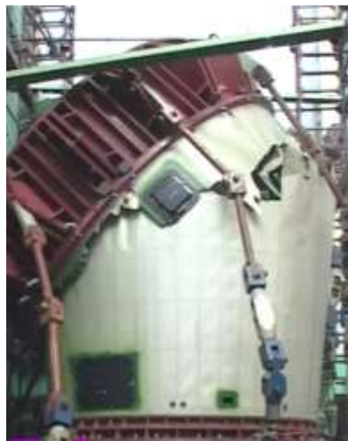
Рисунок 3.8 – Руйнування міжступеневого відсіку
