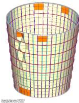
Рисунок 3.10 – Форма руйнування (розрахункове руйнівне навантаження T_{кр.} = 287,493 тс)
