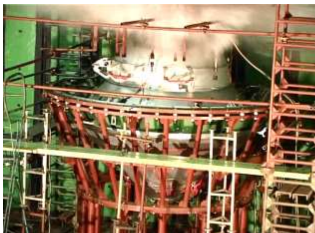
Рисунок 4.15 – Початок процесу руйнування ТВ 3-ої ступені
