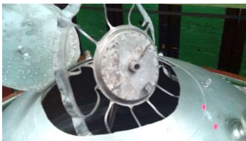
Рисунок 4.17 – Місце руйнування ТВ 3-ої ступені
