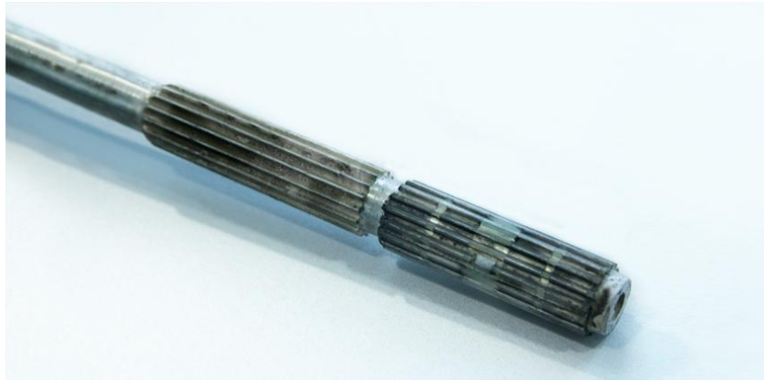
Рисунок 1.4 – Корозія на шліцьовому з'єднанні травмобезпечного валу (одна з причин хрусту під час повороту керма)
