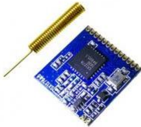
Рисунок 2.4 – Модем LoRa 433 МГц на чіпі SX1278
