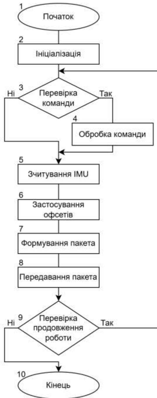
Рисунок 3.3 – Схема алгоритму роботи фізичного контролера
