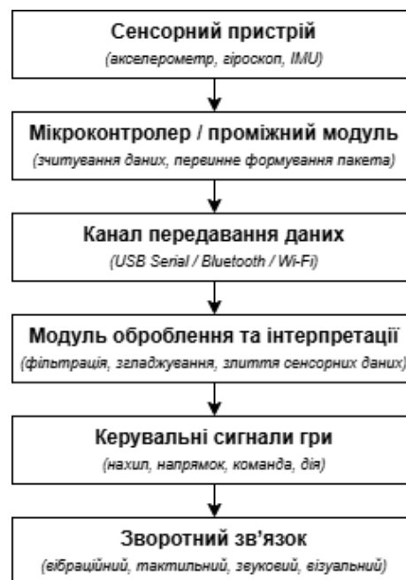
Рисунок 1.2 – Узагальнена схема процесу передавання та використання сенсорних даних в інтерактивній грі з матеріальним інтерфейсом [3]-[4]
