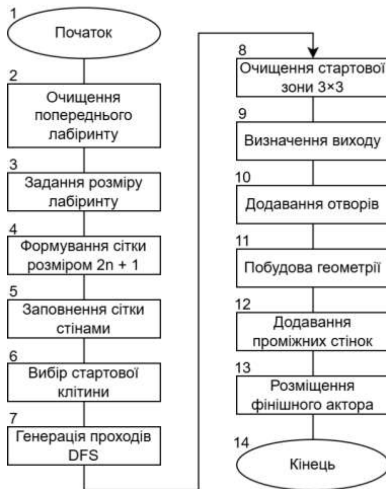
Рисунок 3.9 – Схема алгоритму процедурної генерації лабіринту
