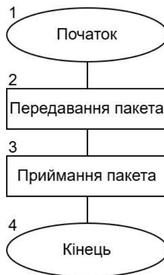
Рисунок 3.4 – Схема алгоритму серійного обміну між апаратною та програмною частинами
