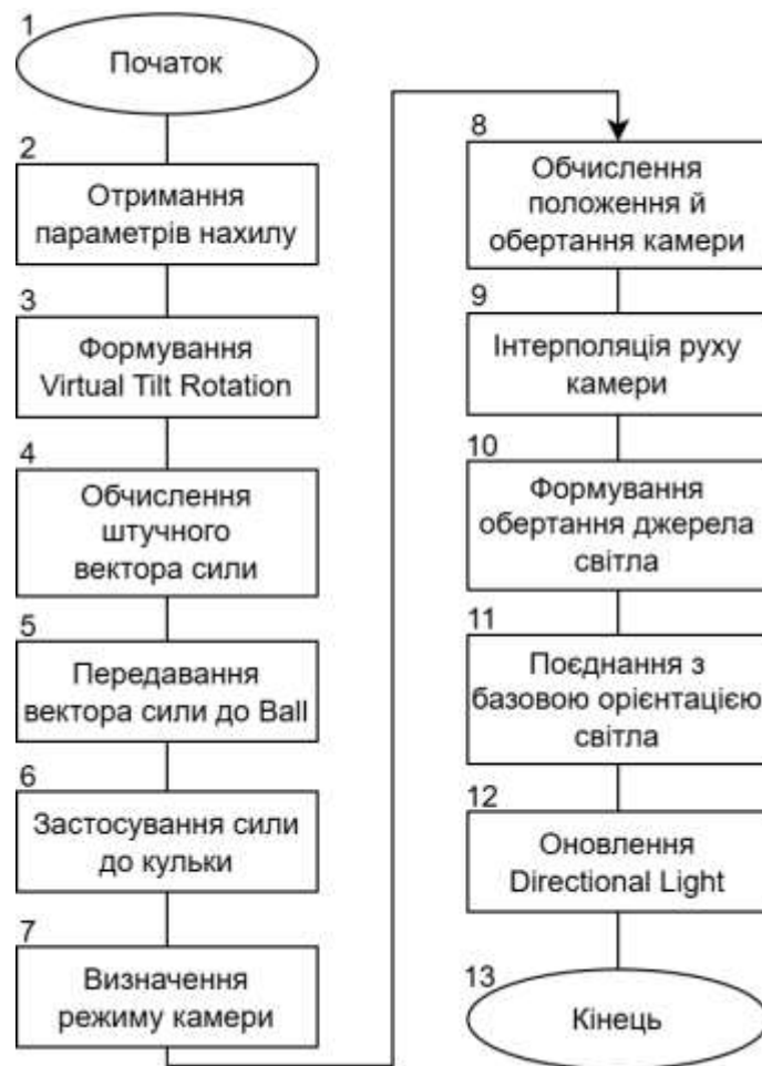
Рисунок 3.7 – Схема алгоритму керування сценою для імітації нахилу лабіринту
