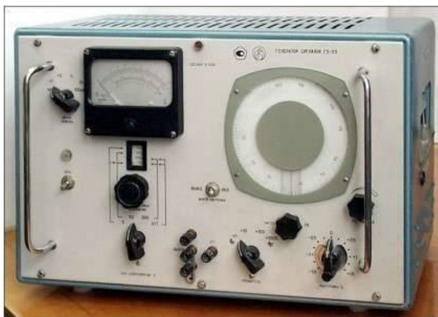
Рисунок 5.2 – Передня панель генератора ГЗ-34
