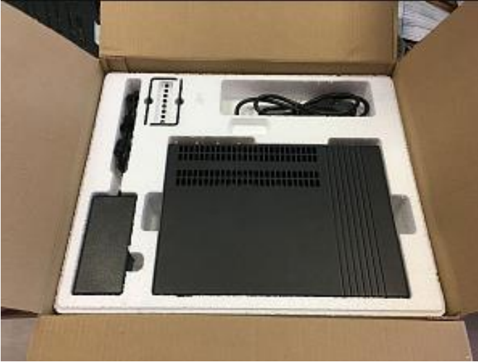
Рисунок 3.13 – Ложемент з пінопласту та картону для безпечного транспортування електронного пристрою з картону та пенопласту
