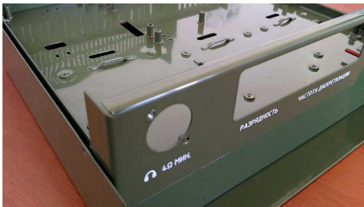
Рисунок 3.10 – Штампований корпус РЕЗ з відбортунням стінок
