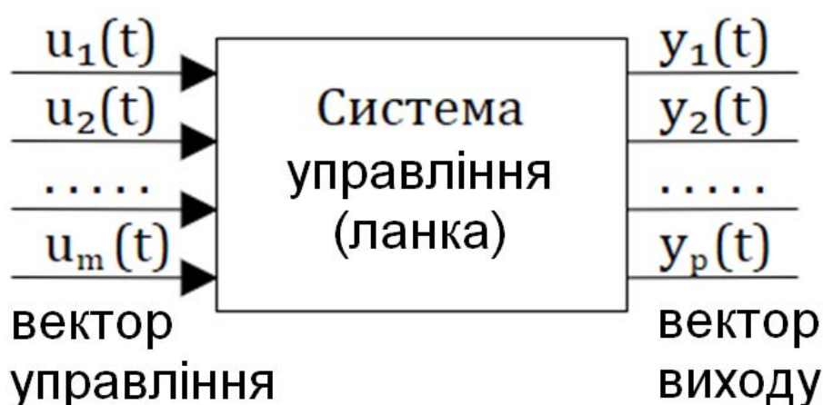
Рисунок 1.4 – Схематичне представлення багатовимірної системи управління
