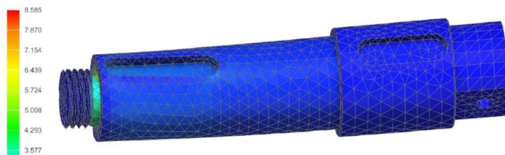
Рисунок 2.8 – Результат розрахунку напружено-деформованого стану деталі
