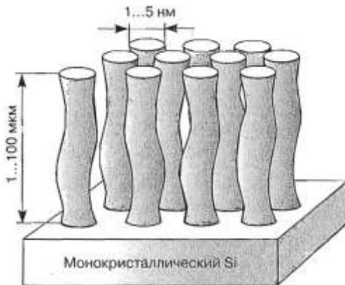
Рисунок 3.2 - Високопористий кремній у вигляді «щітки» з квантових ниток, отриманих електрохімічним травленням поверхні монокристалічного кремнію
