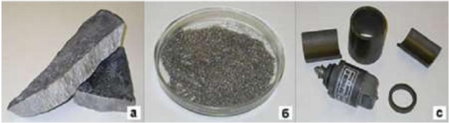
а - зливки, б - аморфний порошок, в - вироби Рисунок 2.2 - Магнітні нанокомпозити
