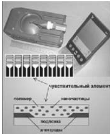
Рисунок 2.3 - Схема «електронного носа»
