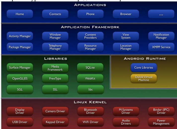
Рисунок 2.1– Архітектура OS Android
