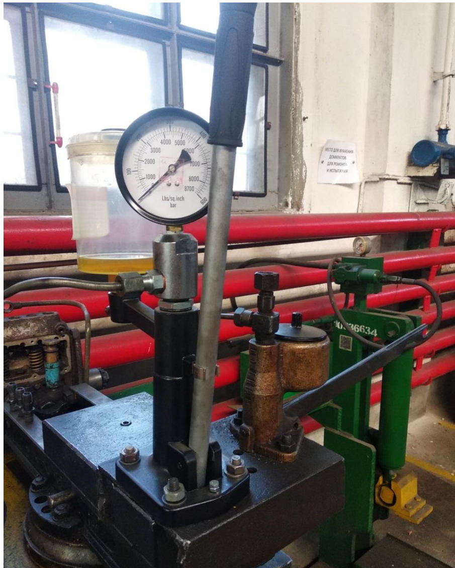
Рисунок 2.7 – Стенд для перевірки дизельних форсунок з калібровочним ручним насосом ЛТС 4818
