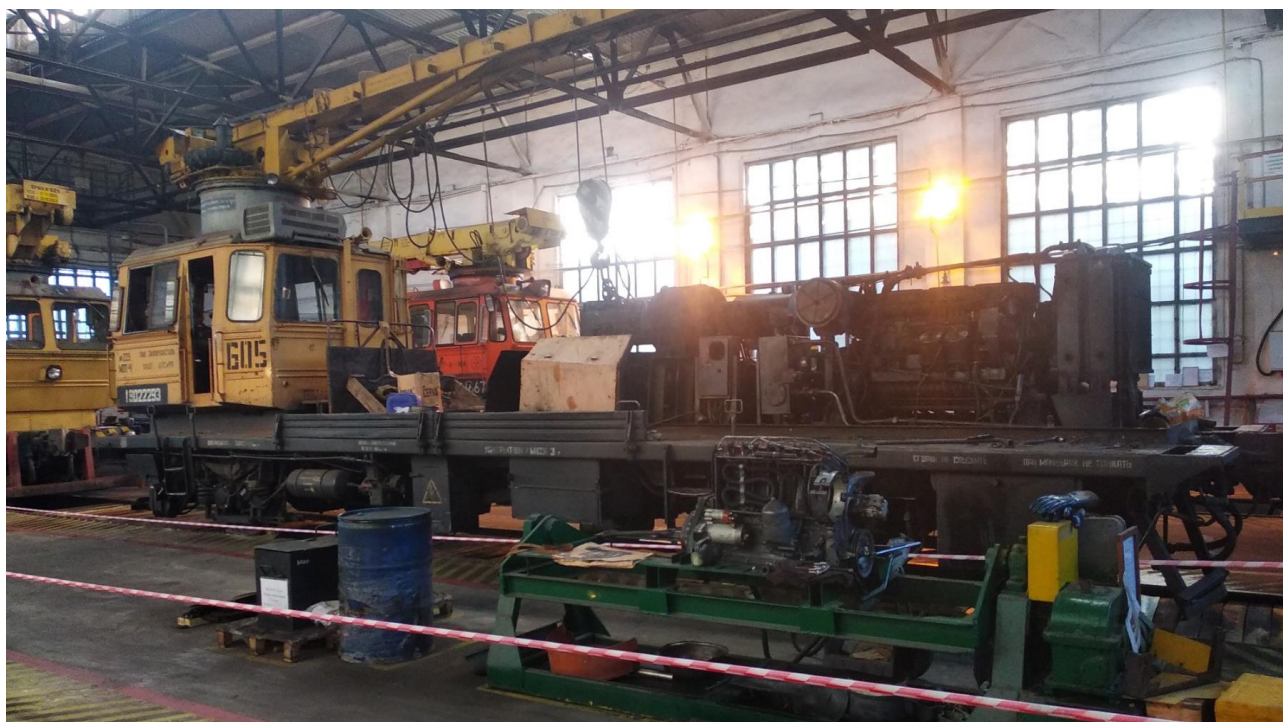
Рисунок 2.1 – Машина МПТ-4 на ремонті і обслуговуванні в цеху поточного підтримання і ремонту шляху УЖДТ ПАТ «Запоріжсталь»
