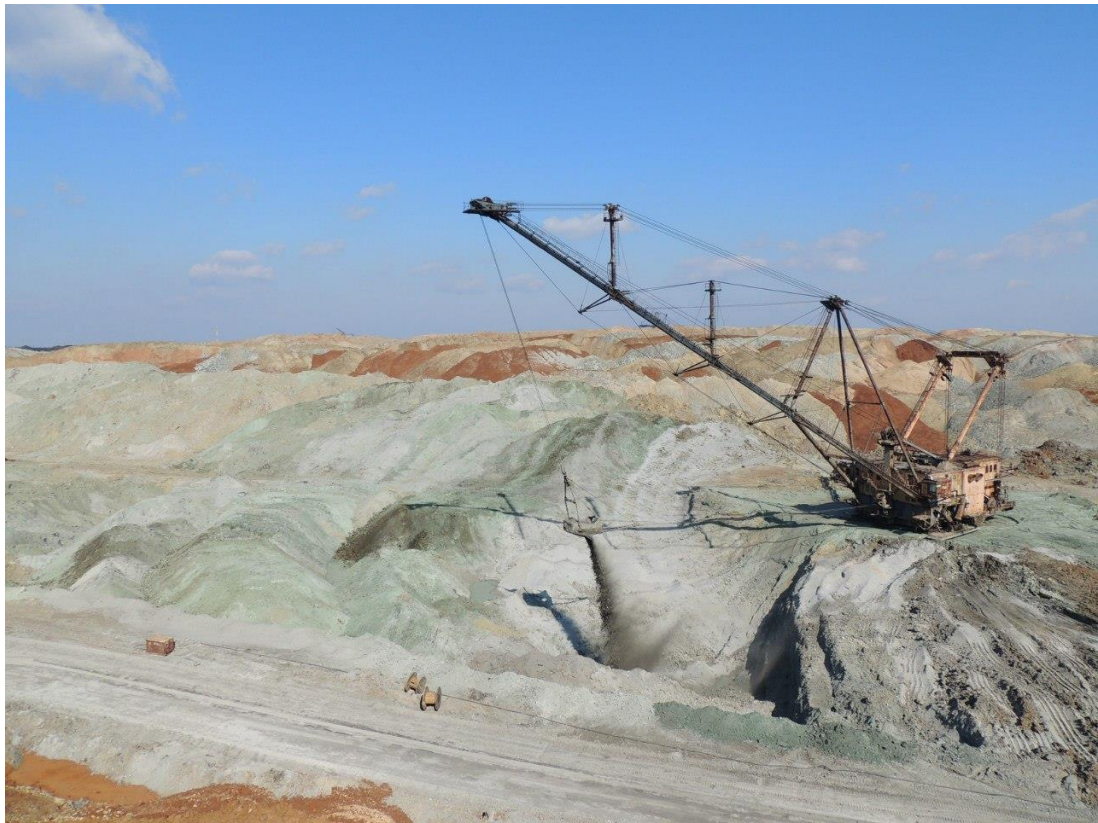
Рисунок 1.10 – Крокуючий екскаватор в роботі
