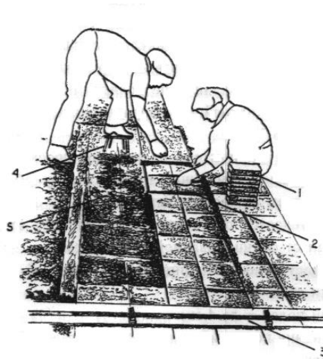
Рисунок 3.5 Укладання плиток на прошарок із розчинової суміші за допомогою клітинного шаблону:
