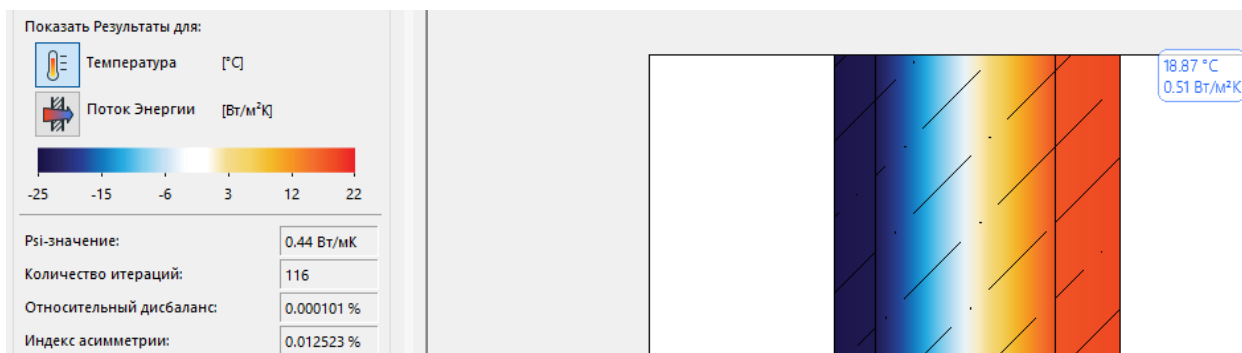
Рисунок 6.28 – Температура 18.87°C у внутрішньої поверхні стінової панелі змодельованої за новими нормативними показниками та новими показниками температури зовнішнього та внутрішнього повітря
