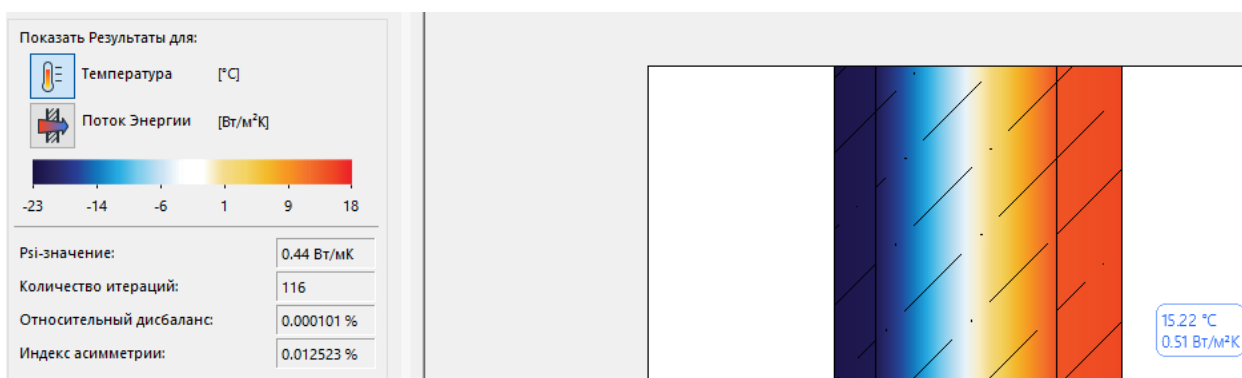
Рисунок 6.27 – Температура 15.21°C у внутрішньої поверхні стінової панелі змодельованої за новими нормативними показниками та старими показниками температури зовнішнього та внутрішнього повітря
