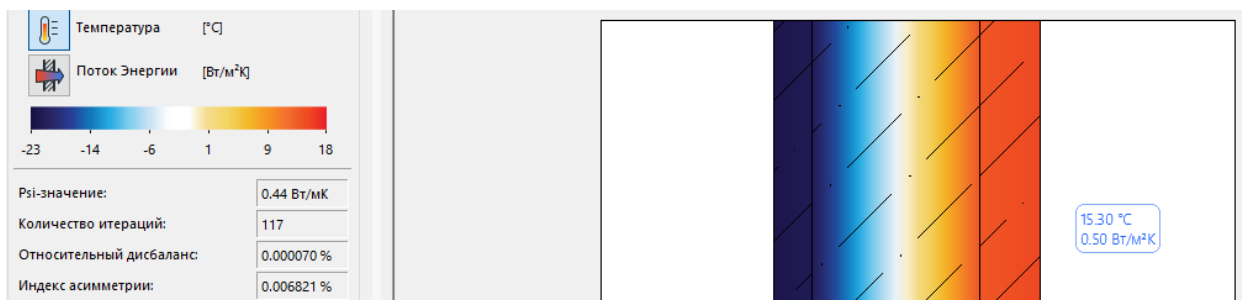
Рисунок 3.26 – Температура 15.30°C у внутрішньої поверхні стінової панелі змодельованої за старими нормативними показниками
