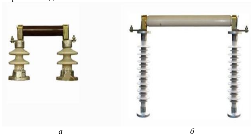
Рисунок 15.3 – Запобіжники типу ПКН призначені для захисту трансформаторів напруги на номінальні напруги 10 кВ (ПКН 001-10) (а) та 35 кВ ПКН 001-35 (б) частотою 50 Гц
