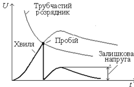
Рисунок 14.8 – Захист ізоляції трубчастим розрядником
