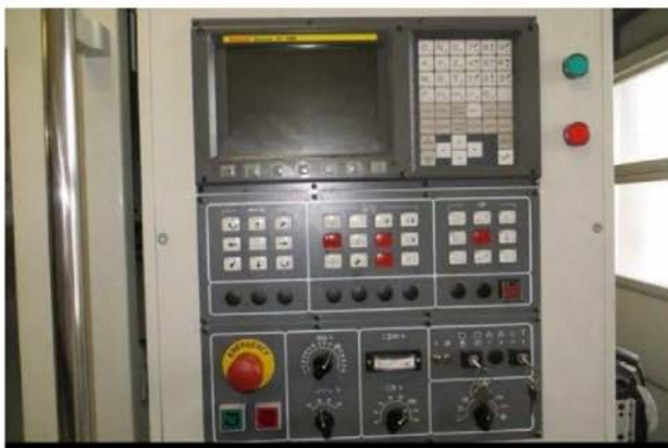
Рисунок 2 – Панель управління вертикально-фрезерного верстату MCV-2418
