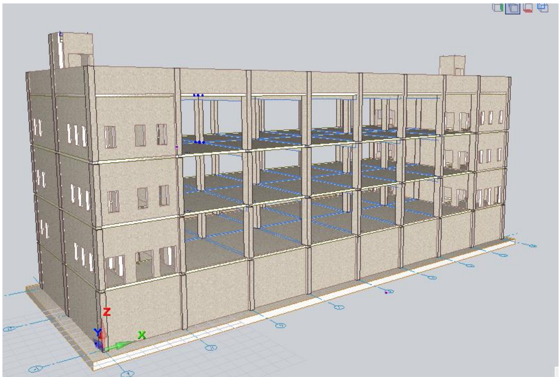
Рисунок 3.1 – Каркас будівлі у ПК САПФІР
