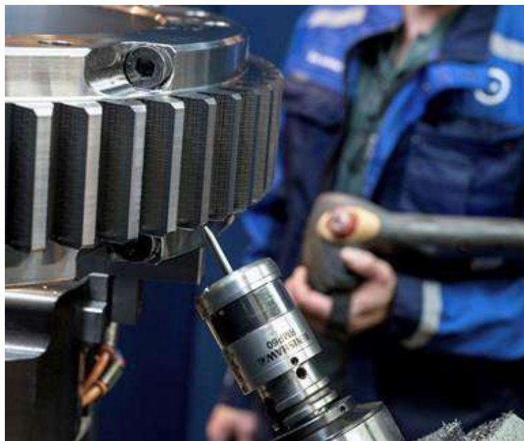
Рисунок 3.1 – Роботизований комплекс перевіряє розміри готової шестерні після видалення задирок [12]
