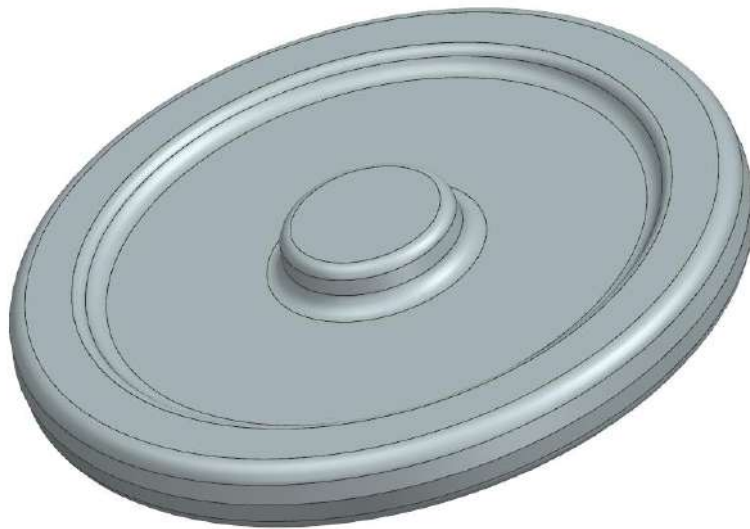
Рисунок 1.2 – 3D-модель заготовки, що отримується на КГШП
