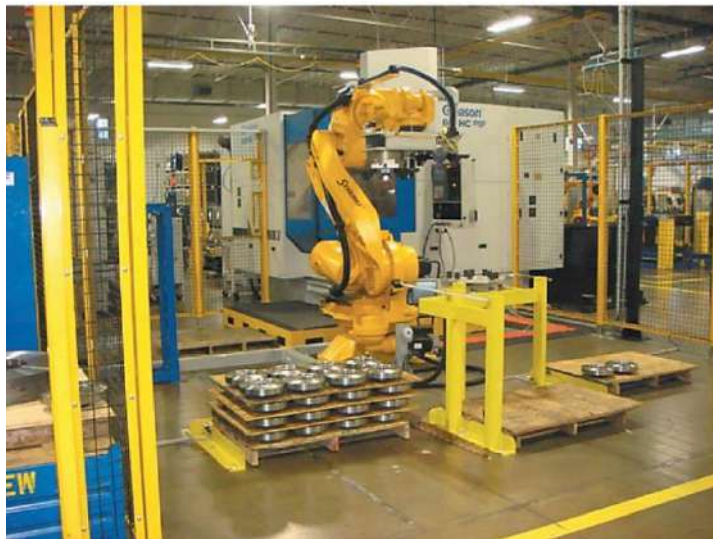
Рисунок 5.7 – Роботизовані модулі для видалення задирок [15]
