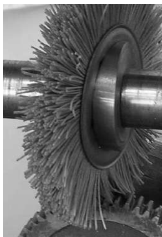
Рисунок 5.5 – Зачистка задирок абразивно-полімерною щіткою [15]
