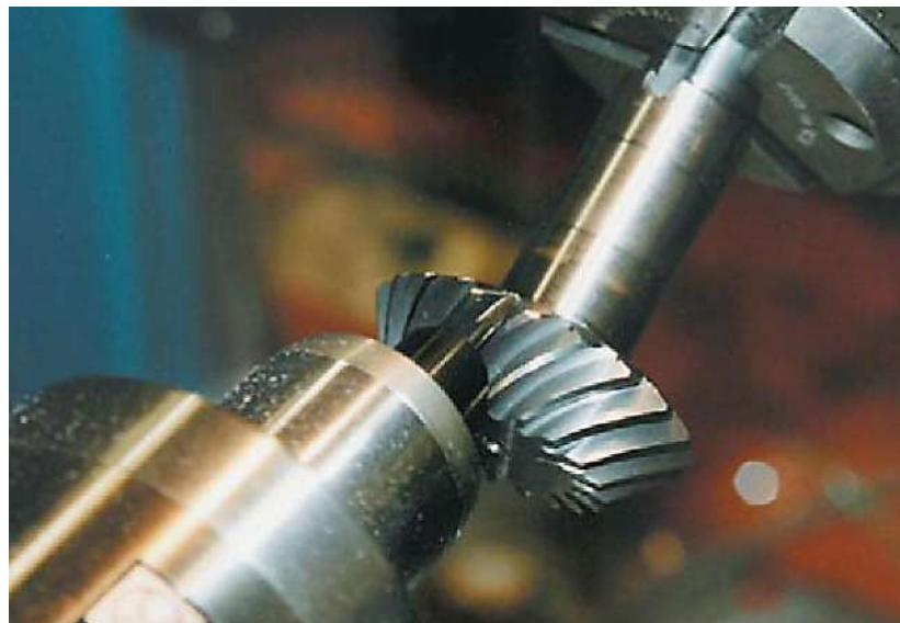
Рисунок 5.2 – Твердосплавна фреза знімає задирки на зубчастому колесі [15]
