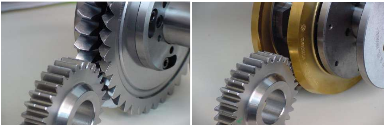
Рисунок 5.6 – Зачистка задирок методом пластичної деформації [15]
