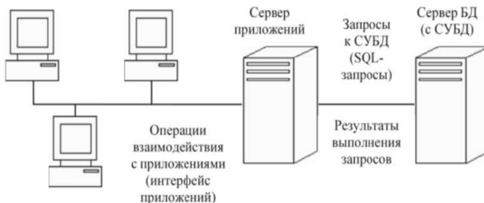
Рисунок 3.4 – Триланкова модель клієнт сервер [8]
