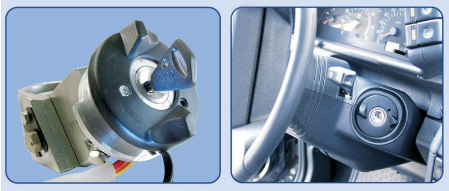
Рисунок 11.6 - Автоматичні блокіратори рульового вала
