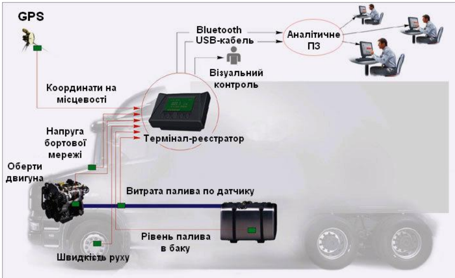
Рисунок 11.18 - Схема системи контролю витрат палива
