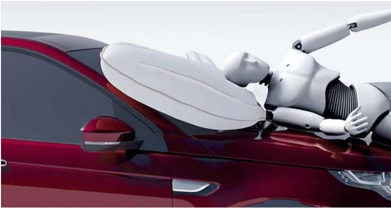
Рисунок 10.20 - Активний капот з подушкою захисту пішоходів
