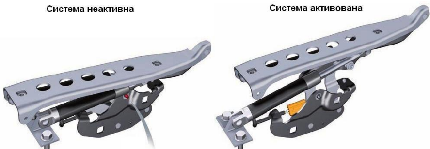
Рисунок 10.18 - Виконавчі пристрої активного капота
