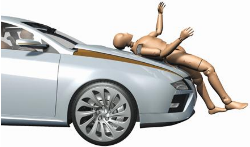
Рисунок 10.19 - Активний капот системи захисту пішоходів
