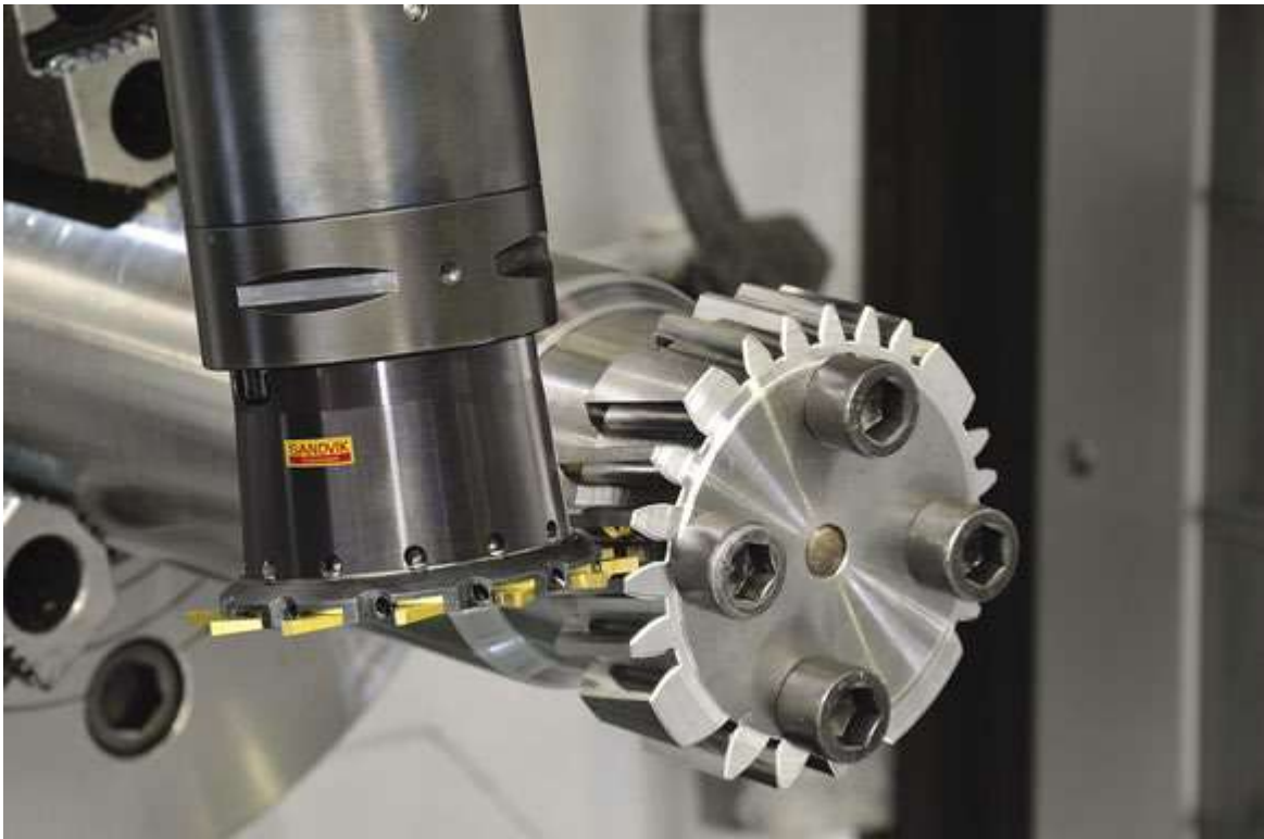
Рисунок 4.2 – Отримання зубів на токарно-фрезерному верстаті [7]
