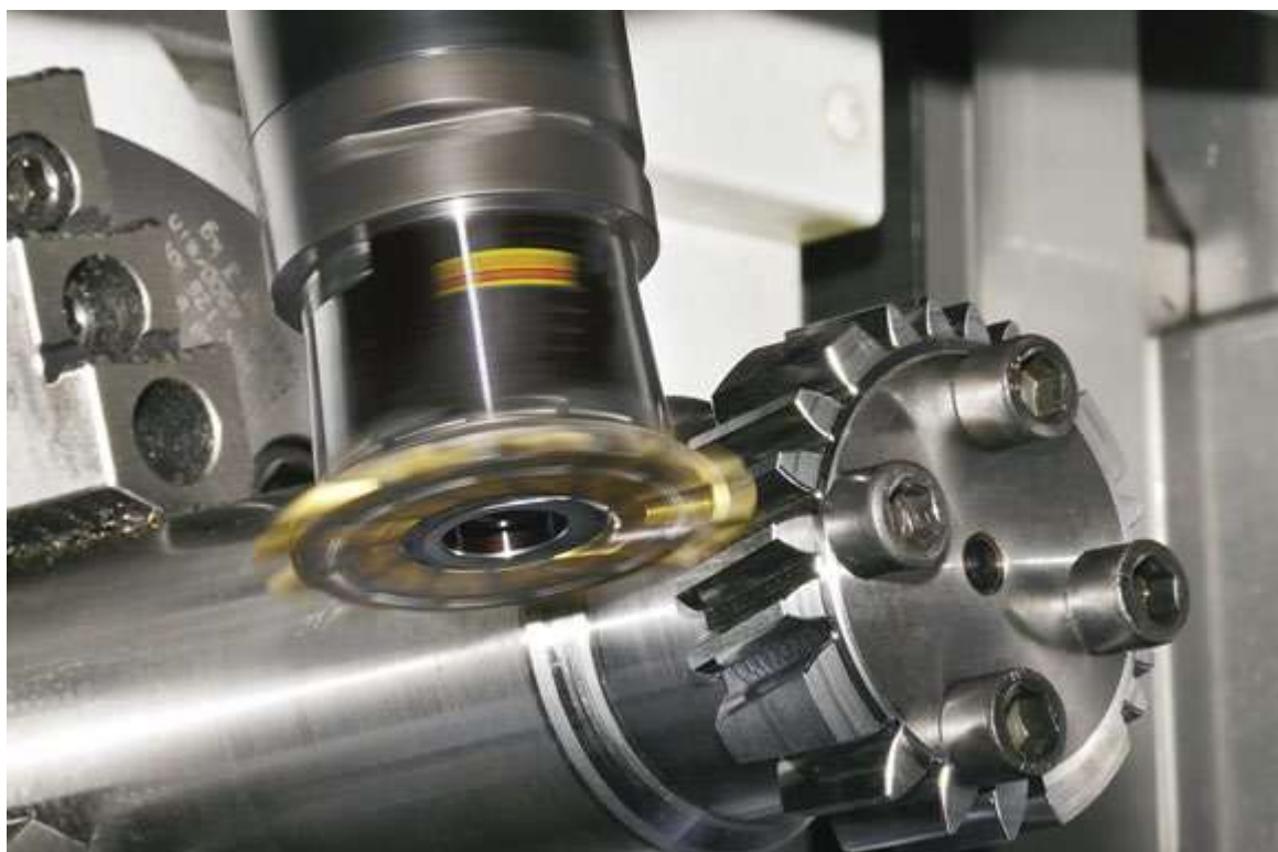
Рисунок 4.1 – Отримання зубів фрезами Sandvich [7]
