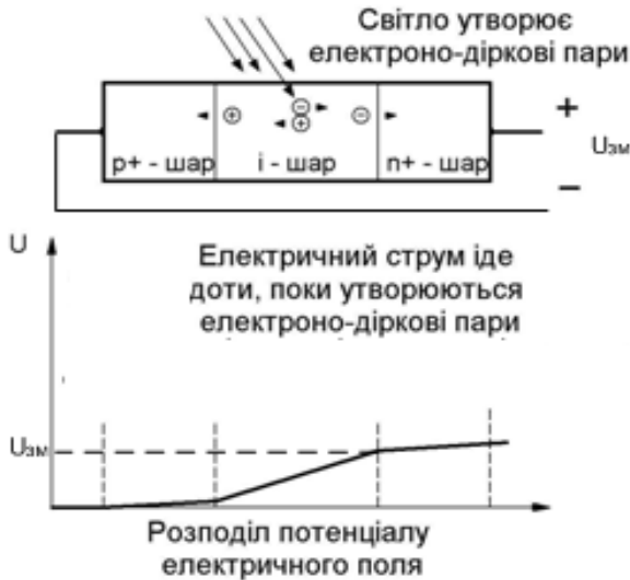
Рисунок 2.6 – Структура розподілу потенціалу електричного поля p - i - n ФД
