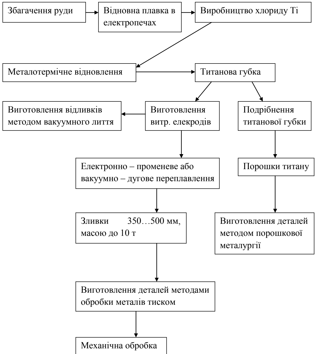
Рисунок 1.1 – Схема виробництва титану.
