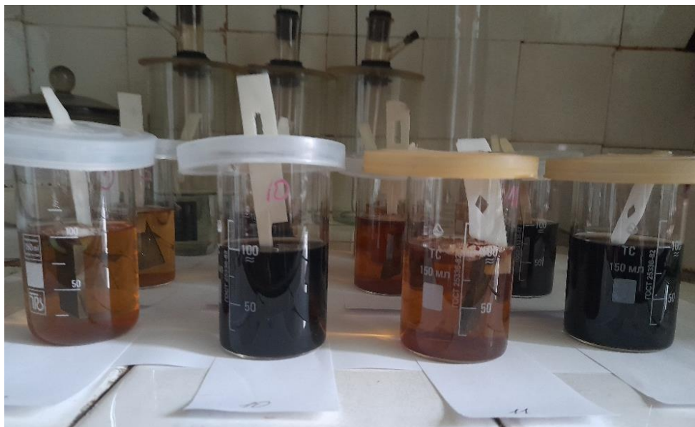
Рисунок 3.4 – Розчини на основі рослинних екстрактів після 72 годин зі зразками сталі Ст1пс
