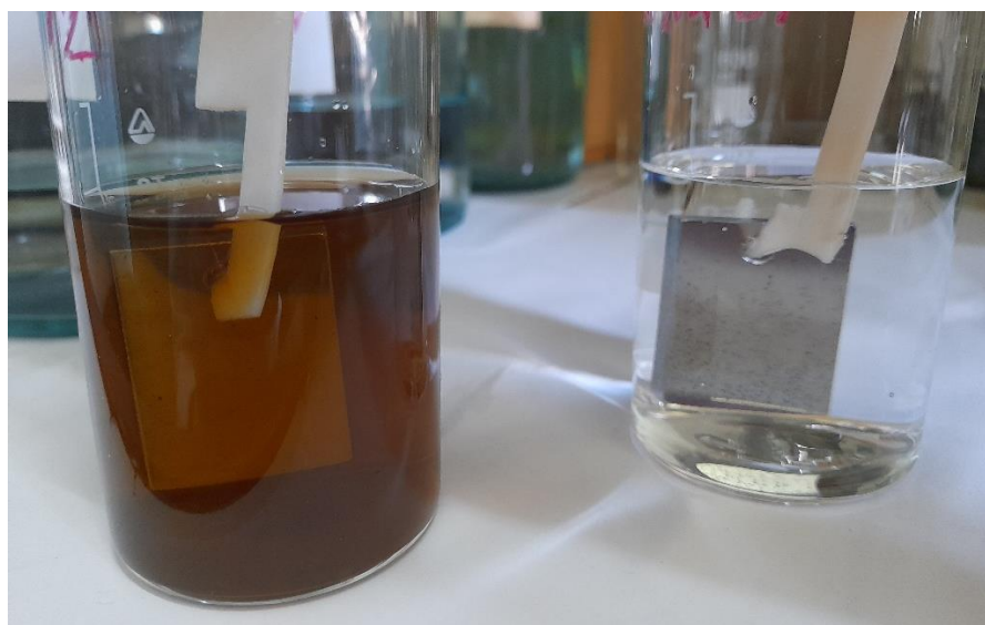
Рисунок 3.3 – Процес корозії на початку дослідження у 3%-му розчині NaCl та з додаванням інгібітора корозії на сталі 30ХГСА
