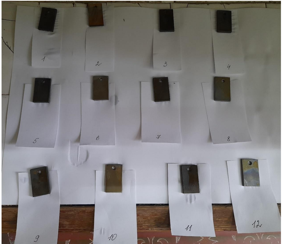
Рисунок 3.8 – Зразки сталі Ст1пс після 72 год в корозійному середовищі
