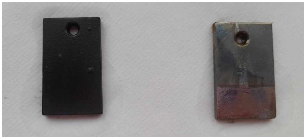
Рисунок 3.9 – Зразки Ст1пс після 72 год в чистих розчинах H_2SO_4 та NaCl
