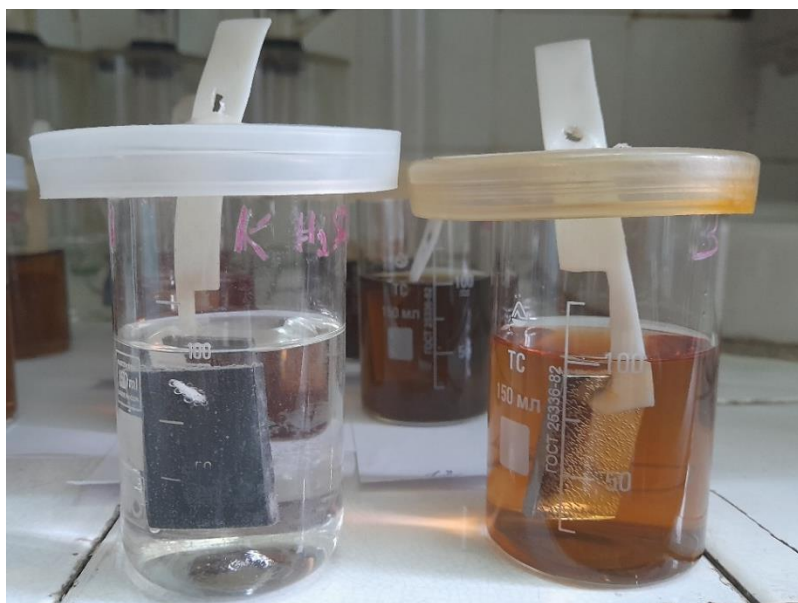
Рисунок 3.1 – Процес корозії на початку дослідження у розчині сірчаної кислоти та з додаванням інгібітора корозії на сталі Ст1пс
