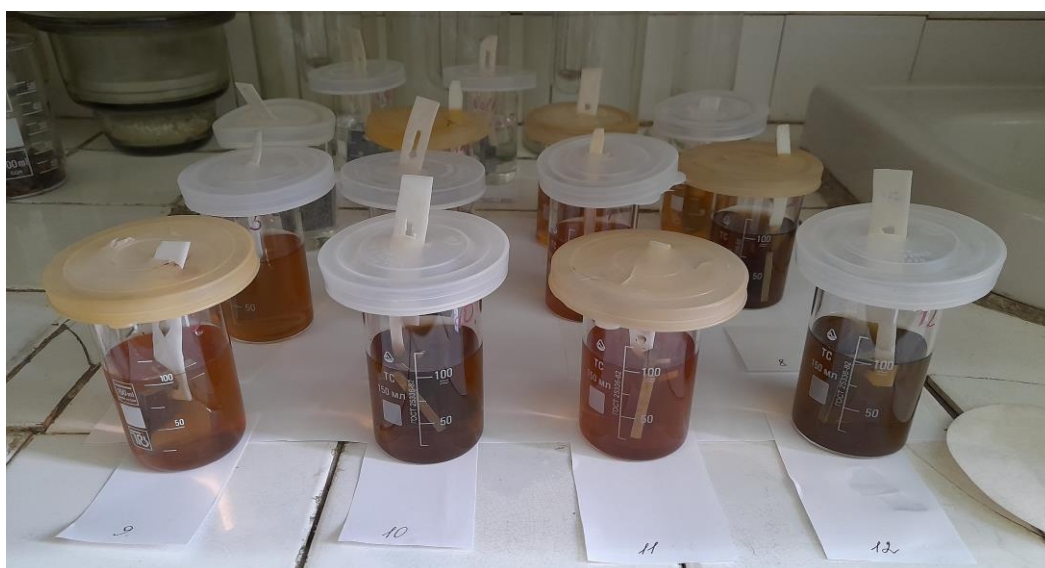
Рисунок 2.11 – Дослідження зразків сталі 30ХГСА в корозійних середовищах з інгібіторами на основі рослинних екстрактів
