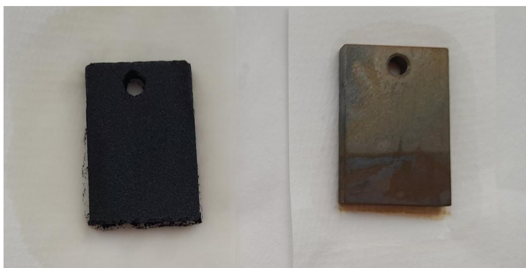
Рисунок 3.11 – Зразки 30ХГСА після 72 год в чистих розчинах H_2SO_4 та NaCl
