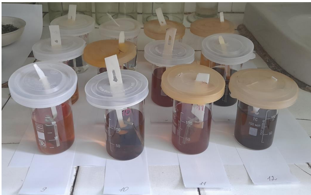
Рисунок 2.10 – Дослідження зразків Ст1пс в корозійних середовищах з інгібіторами на основі рослинних екстрактів
