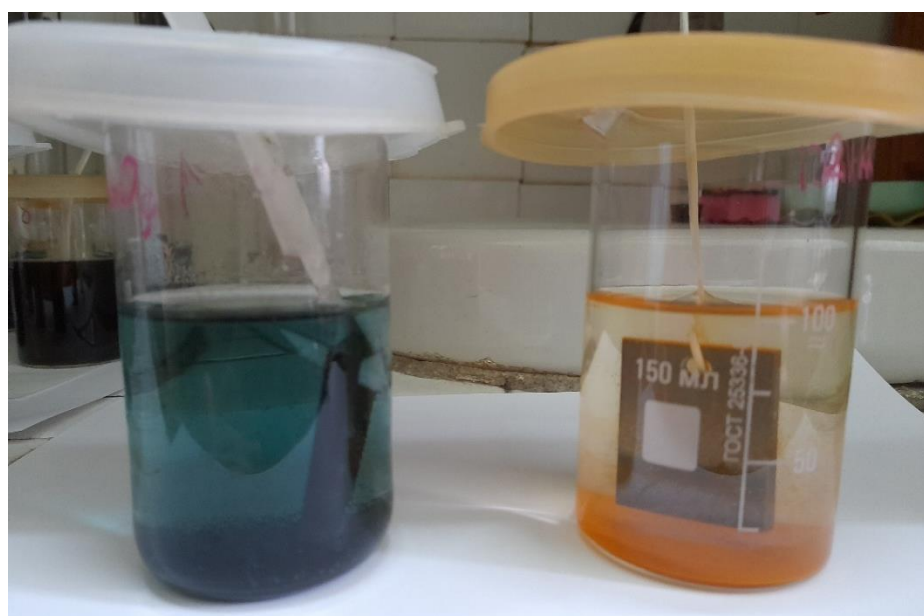
Рисунок 3.7 – Процес корозії сталі 30ХГСА в розчинах H_2SO_4 та NaCl без рослинних інгібіторів після 72 год
