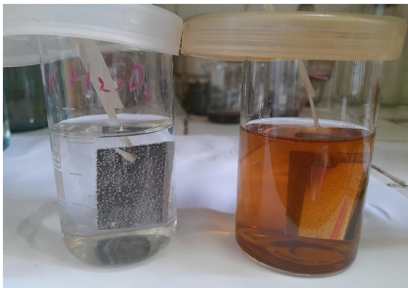
Рисунок 3.2 – Процес корозії на початку дослідження у розчині сірчаної кислоти та з додаванням інгібітора корозії на сталі 30ХГСА
