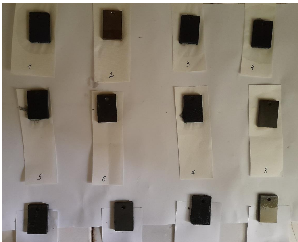
Рисунок 3.10 – Зразки сталі 30ХГСА після 72 год в корозійному середовищі
