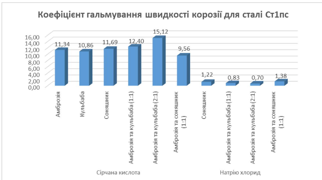
Рисунок 3.18 – Коефіцієнт гальмування швидкості корозії для сталі Ст1пс у 10%-му розчині H_2SO_4 та 3%-му розчині NaCl
