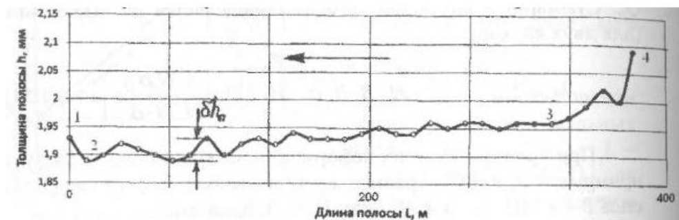
Рис. 2.1. Профілограмма зміни товщини по довжині смуги (ст.08пс) при прокатці без Койлбокс. Дані меткомбінату "Запоріжсталь" (одинарний рулон).
