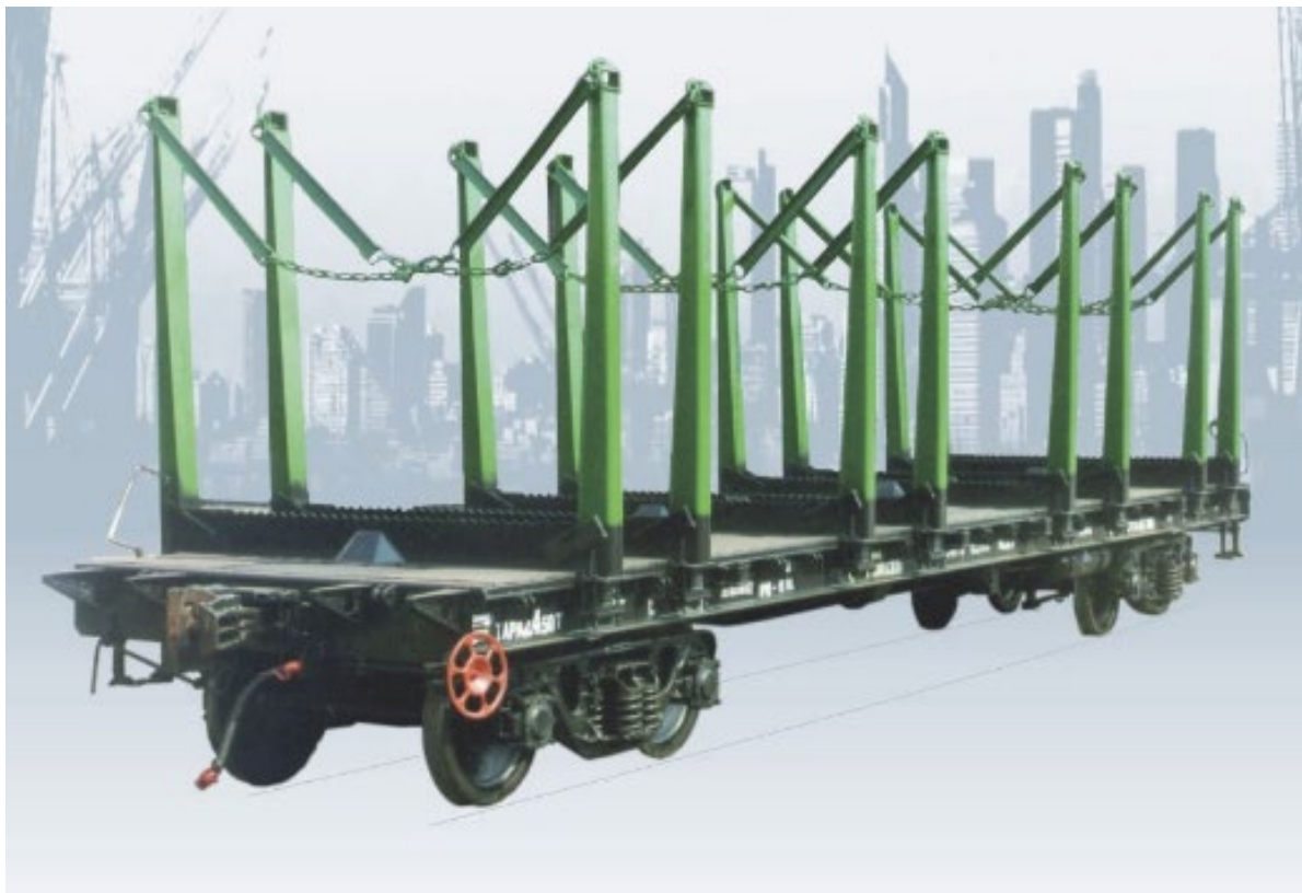
Рисунок 2.2 – Вагон-платформа для лісоматеріалів виробництва Дніпровагонмаш
