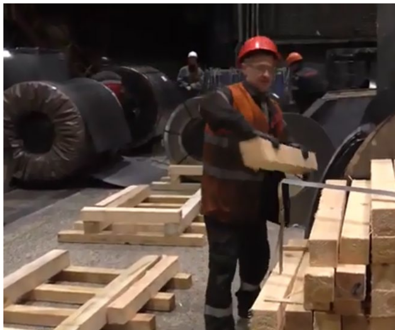
Рисунок 1.5 – Розформування пакету пиломатеріалів для виготовлення піддонів
