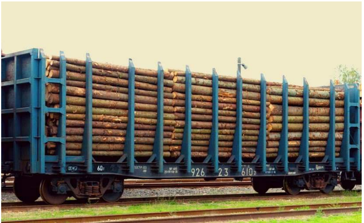
Рисунок 1.10 – Розміщення лісоматеріалів у спеціалізованому вагоні
