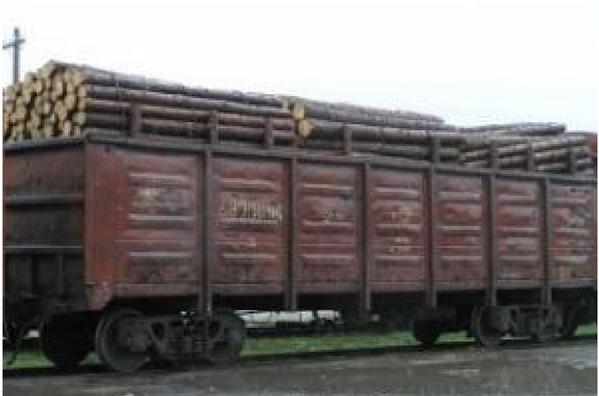
Рисунок 1.9 – Спосіб розміщення лісоматеріалів у піввагоні
