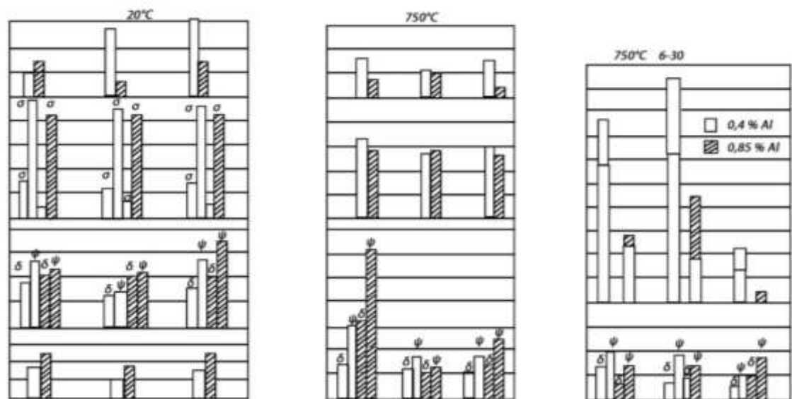
Рисунок 2.7 – Механічні властивості та довготривалу міцність в залежності від швидкості охолодження при гартуванні 1180°C [14]
