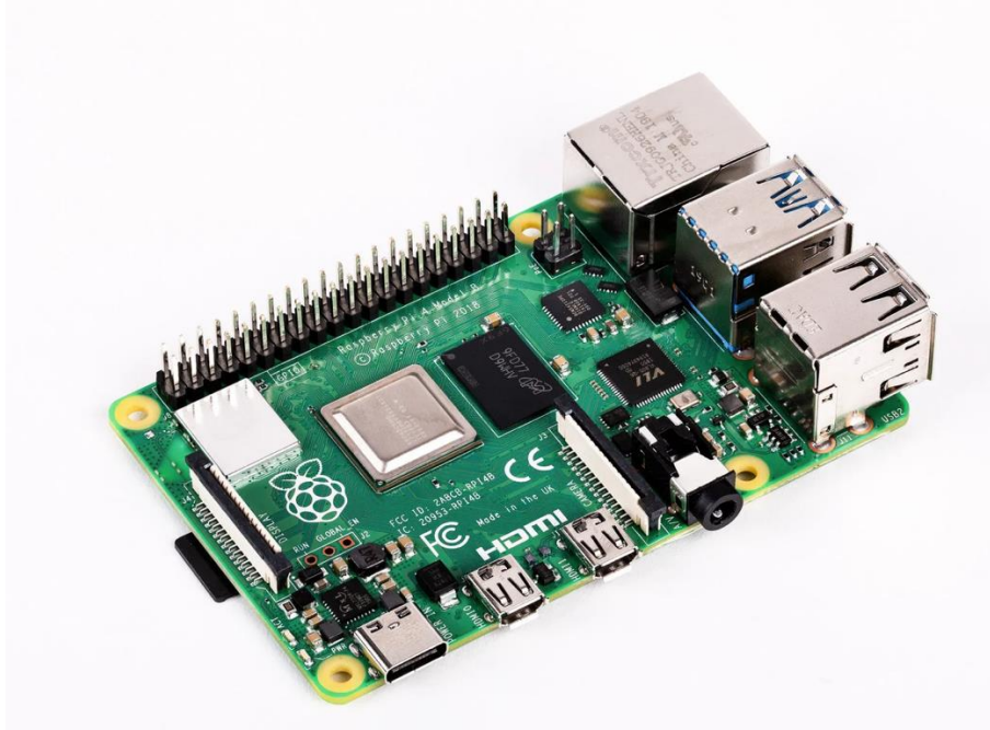
Рисунок 3.2 – Приклад мікрокомп'ютера Raspberry Pi
