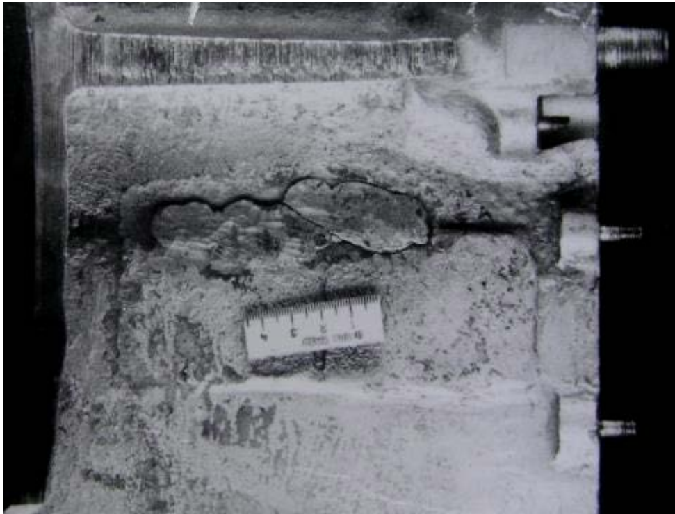
Рисунок 3.2 – Тріщина в місці заварки корпусного виливка, \times 0,3
