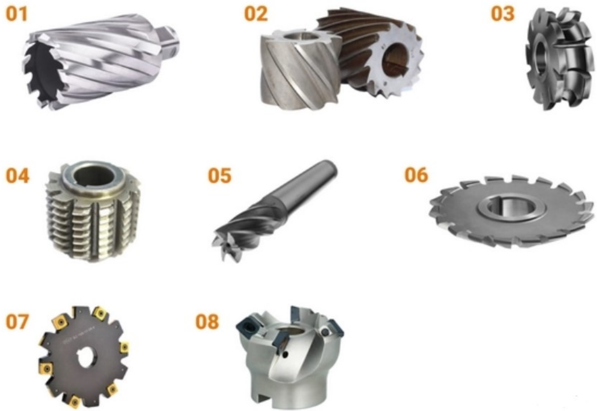
Рисунок 1.6 – Різні види різального інструменту (фрез) для обробки заготовок на фрезерному верстаті
