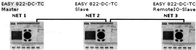
Рисунок. 8.14 - Мережеве з'єднання програмованих реле
