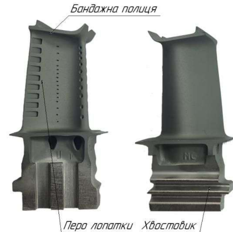
Рисунок 1.1 – Зовнішній вигляд робочої лопатки турбіни з типовою розміткою на ділянки
