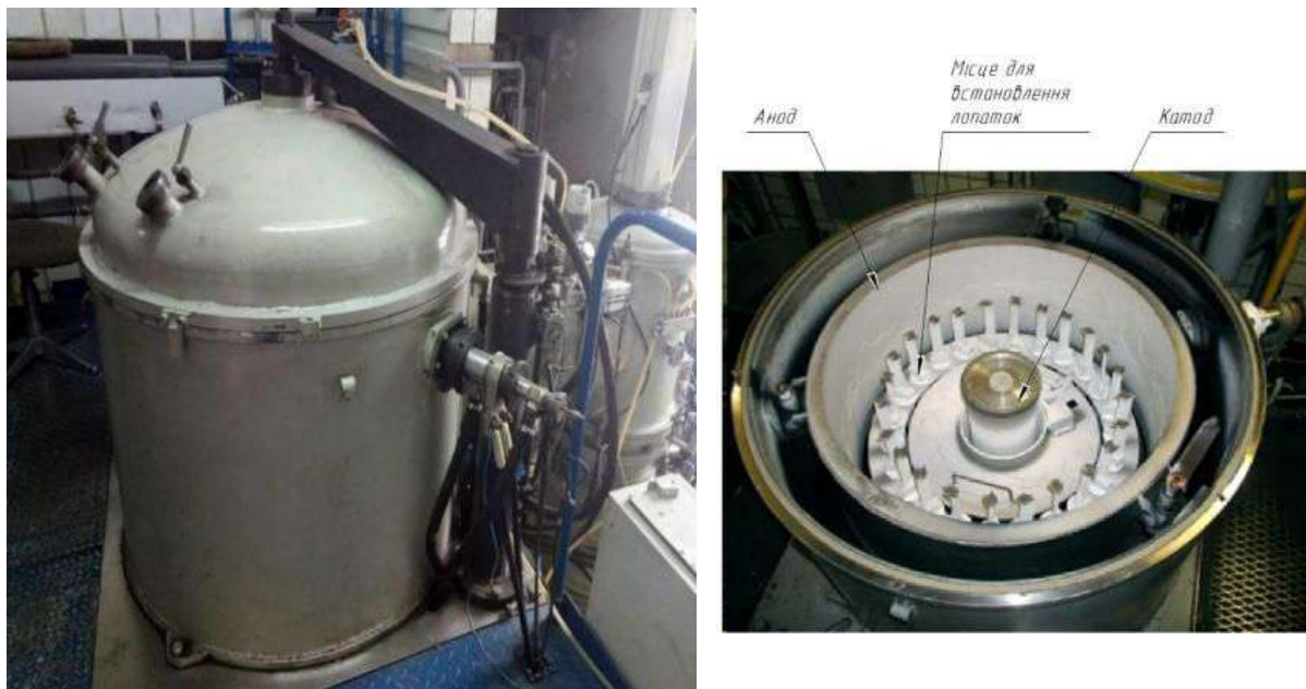
Рисунок 1.5 – Установка для нанесення жаростійкого покриття в вакуумі
