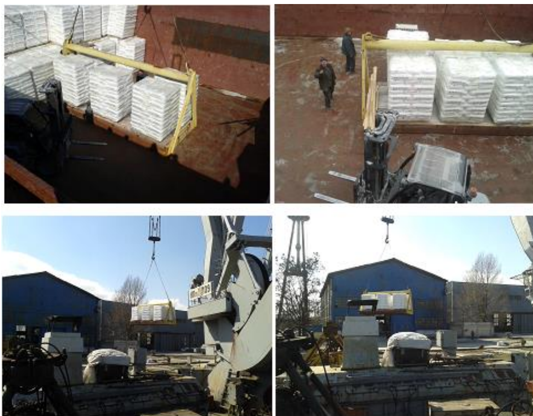
Рисунок 2.3 – Металева рама для перевантаження піддонів з вантажем
