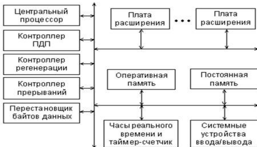
Мал. 7.1. Архітектура персонального комп'ютера типа IBM PC.
