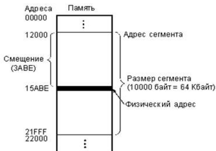
Мал. 3.5. Формування фізичної адреси пам'яті з адреси сегменту і зсуву.
