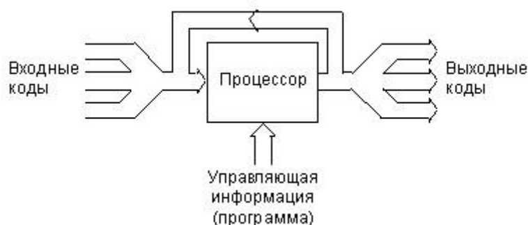
Мал. 1.3. Інформаційні потоки в мікропроцесорній системі.
