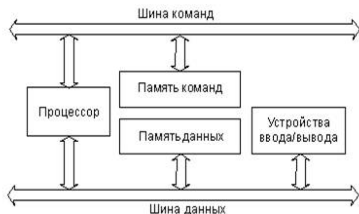
Мал. 1.15. Архітектура з роздільними шинами даних і команд.
