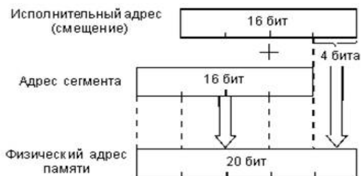
Мал. 3.5. Формування фізичної адреси пам'яті з адреси сегменту і зсуву.
