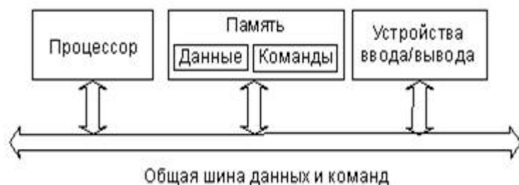
Мал. 1.14. Архітектура із загальною шиною даних і команд.
