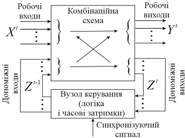
Рисунок 7.1 – Функціональна схема послідовносного автомата
