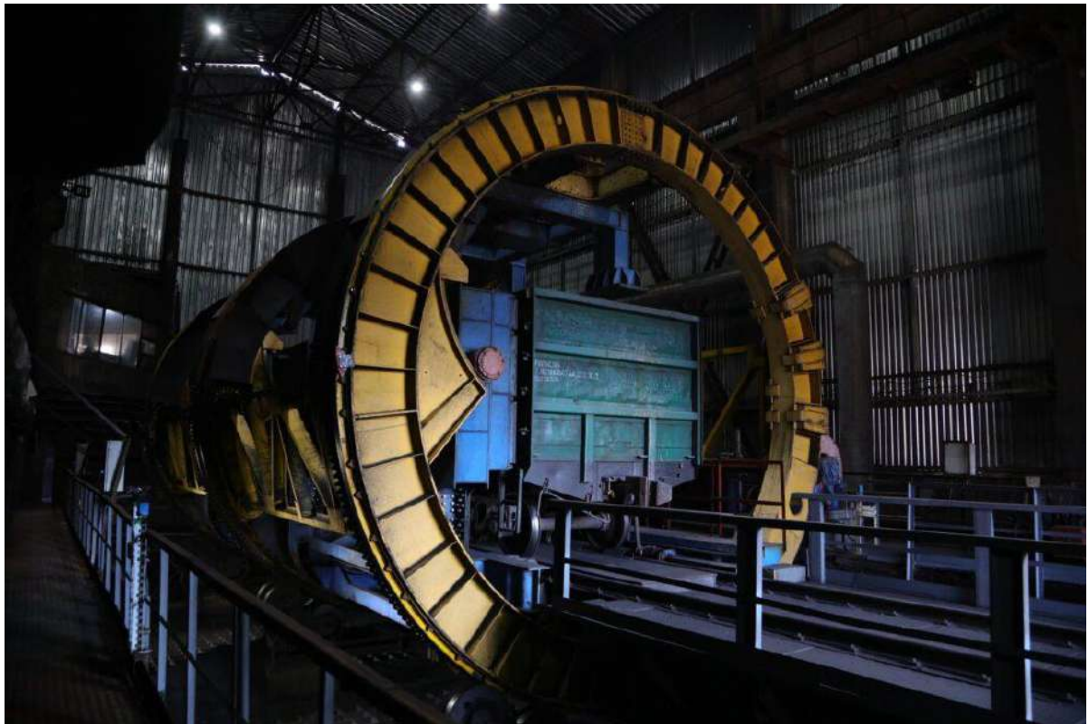
Рисунок 1.4 - Процес вивантаження напіввагонів вагоноперекидачем
