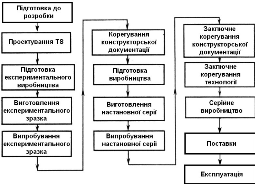
Рисунок 4.2 - Спрощена блок-схема стадій створення й використання технічної системи серійного виробництва
