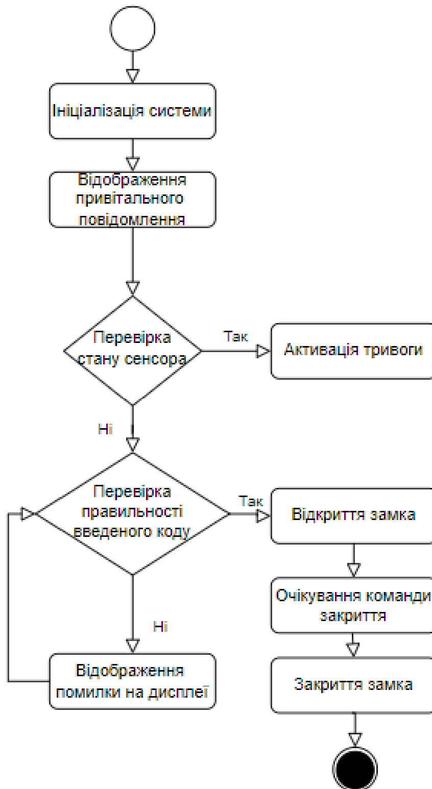
Рисунок 3.2 – Діаграма послідовності роботи системи
