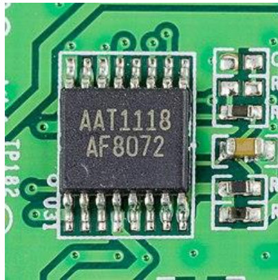
Рисунок 3.2 – Удосконалена аналогова технологія AAT1118 - керований триканальний TFT LCD перетворювач DC-DC
