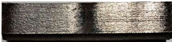
Рисунок 3.3 – Загальний вигляд зразка, виготовленого з матеріалу 2М2А після обробки ПАЩ
