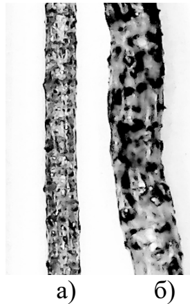
Рисунок 1.22 – Волокна полімерно-абразивних щіток ( \times 10 ): а – ПА волокно (0,6 мм); б – гофроване ПА волокно (1,2 мм) [27].
