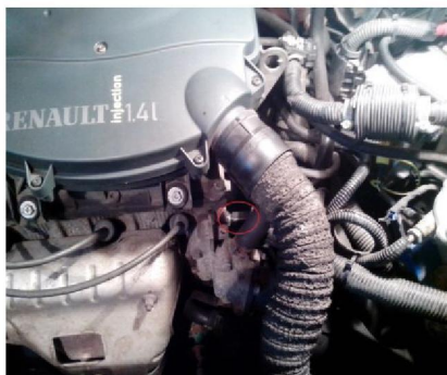
Рисунок 2 – Розташування датчика температури охолоджуючої рідини на двигуні Renault K7J
